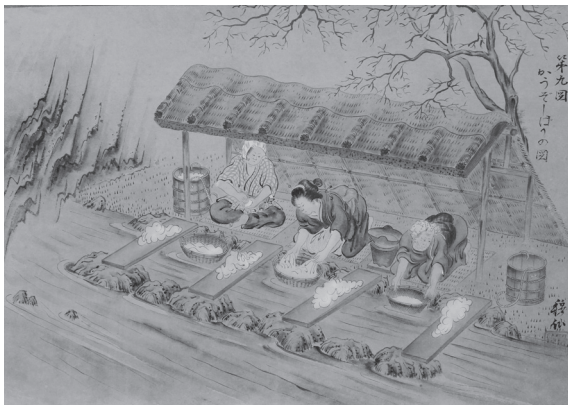
図11 第十図 かうぞを打つ図 並にぬべしを搗き桶に滴す
