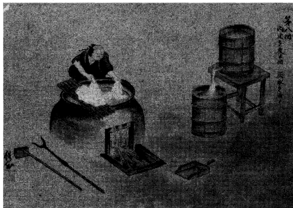
図9 第八図 内皮を煮る図 灰水を滴す
